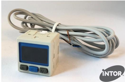
Un presostato digital es un dispositivo que cuenta con un sensor que mide la presión y activa o desactiva una señal eléctrica cuando se detecta un valor establecido. Según el modelo, permite medir presión positiva, negativa (de vacío) o ambas. Son aptos para ser utilizados con aire comprimido o gases no corrosivos.
